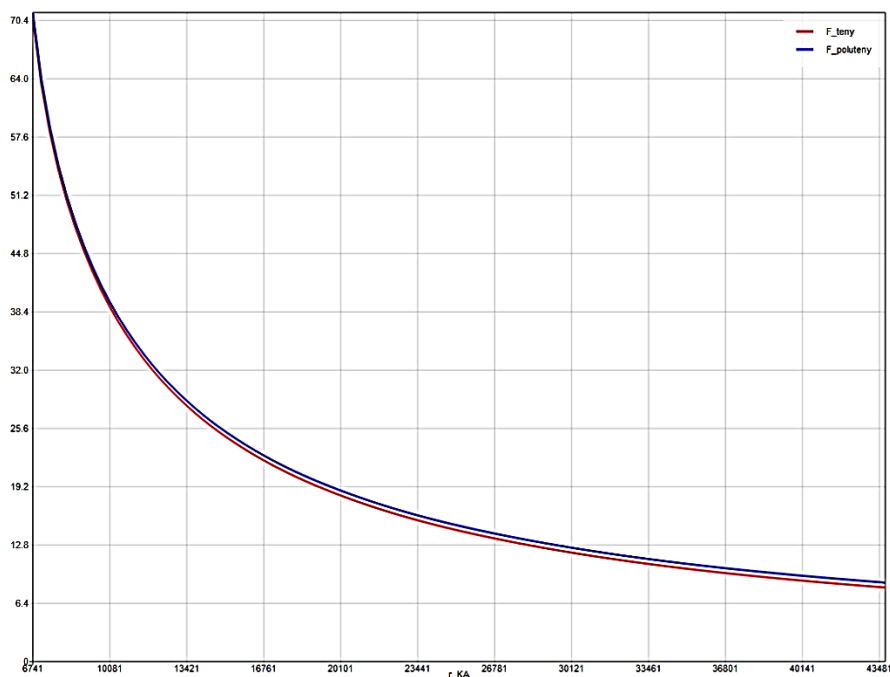
Рис. 3. Зависимость размеров теневых и полутеневых областей от радиуса орбиты КА
